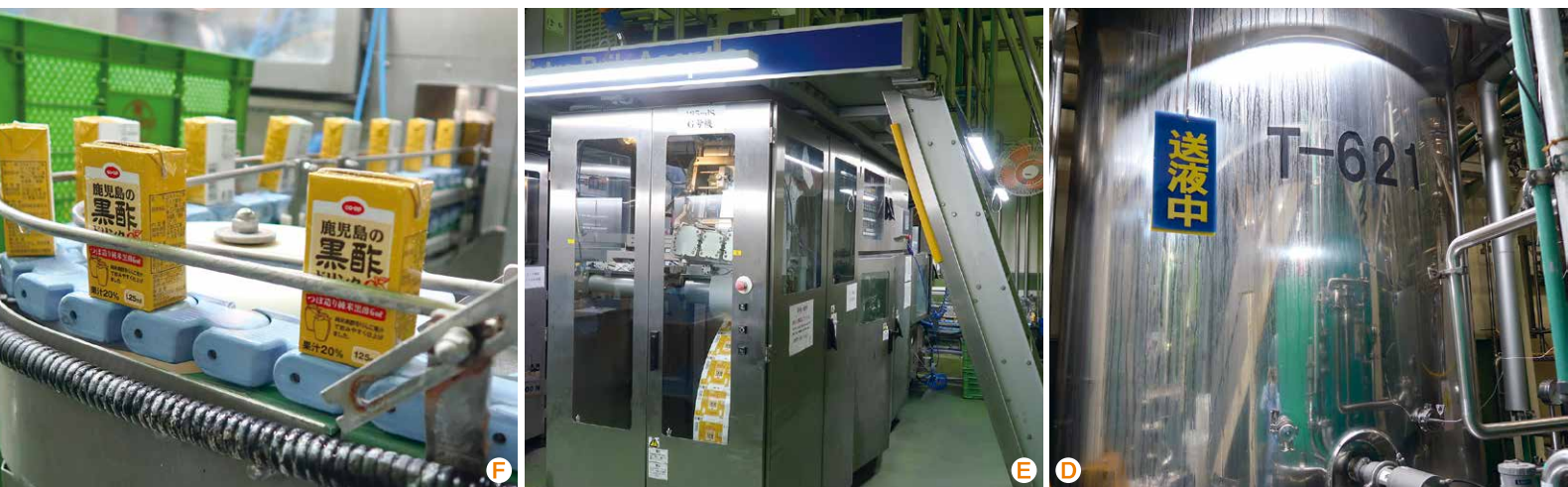
株式会社ふくれんの製造工場では、調合タンクで原材料を調合し(写真D)、異物除去、殺菌を経て充填機で充填し(E)、充填機から出てきた商品(F)に賞味期限を印字し、ストローを付けて箱詰めして出荷します。
