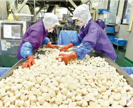
水揚げの様子(写真A)。紋別漁業協同組合は海の目の前に自営の冷凍工場を持ち、水揚げ後すぐ運び、鮮度の良い状態で加工できることが強みです(写真B)。冷凍工場での湯通しの様子(写真C)。湯通しすることで貝から身を取りやすくなり、傷を付けません。取り出したら、人の手で貝殻片、砂粒などを取り除き貝柱の状態にします(写真D)。-33度のトンネルフリーザーを通して急速冷凍します(写真E)。冷凍されたほたてを目で確認しながら、パッキングの工程に進みます(写真F)。
