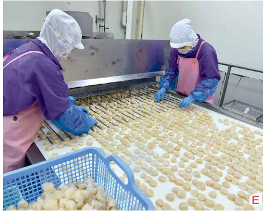
水揚げの様子(写真A)。紋別漁業協同組合は海の目の前に自営の冷凍工場を持ち、水揚げ後すぐ運び、鮮度の良い状態で加工できることが強みです(写真B)。冷凍工場での湯通しの様子(写真C)。湯通しすることで貝から身を取りやすくなり、傷を付けません。取り出したら、人の手で貝殻片、砂粒などを取り除き貝柱の状態にします(写真D)。-33度のトンネルフリーザーを通して急速冷凍します(写真E)。冷凍されたほたてを目で確認しながら、パッキングの工程に進みます(写真F)。
